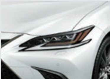
三眼フルLEDヘッドランプ(ロー・ハイビーム) & LEDシーケンシャルターニングナルランプ(フロント)
