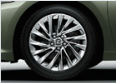
235/45R18タイヤ&ノイズリダクションアルミホイール (ハイパークロムメタリック塗装)*1
