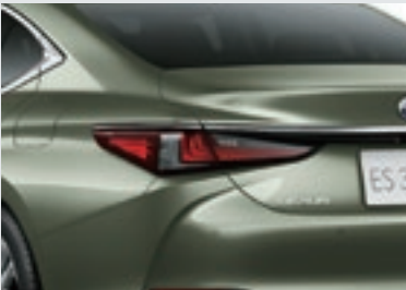
フルLEDリヤコンビネーションランプ (テール・ストップ・バックアップ・ターニングシグナル)
