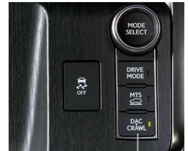
DAC: ダウンヒルアシストコントロールスイッチ CRAWL: クロールコントロールスイッチ
