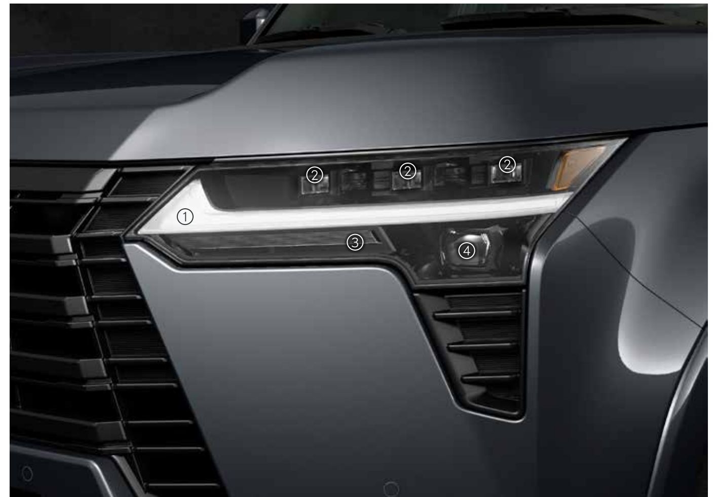
①クリアランスランプ/デイトイムランニングランプ ②ロービーム/ハイビーム ③ターンシグナルランプ ④ブレードスキャン®AHS
