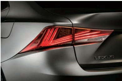
フルLEDリヤコンビネーションランプ (テール・ストップ・バックアップ・ ターニングナル)
