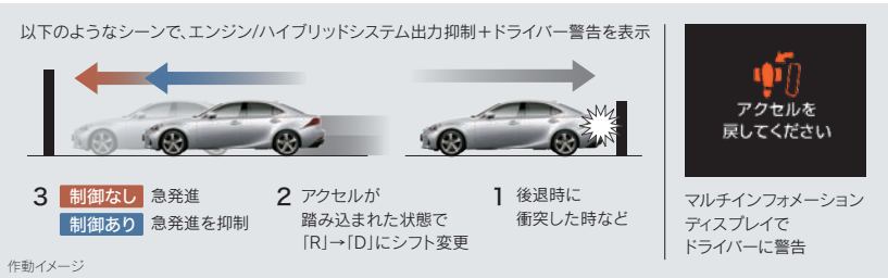
ドライブスタートコントロール
