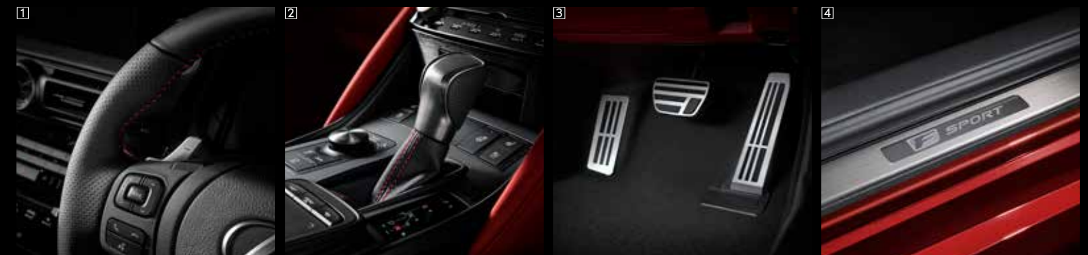
①“F SPORT”専用ディンプル本革ステアリング(バドルシフト付) ②“F SPORT”専用ディンプル本革シフトノブ ③“F SPORT”専用アルミ製スポーツペダル&フットレスト ④“F SPORT”専用スカッフプレート(フロント: ステンレス[“F SPORT”ロゴ])
