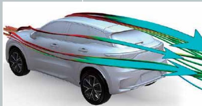
①ルーフ形状・門型スポイラー・リヤコンビネーションランプにより車両後方への流れを適正化しCd値低減・優れた直進安定性を実現
