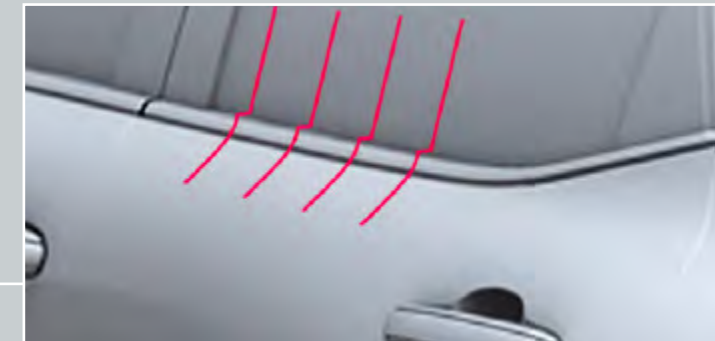
④ベルトモールとボディパネルを面一化、高い整流効果で優れた操縦安定性を実現
