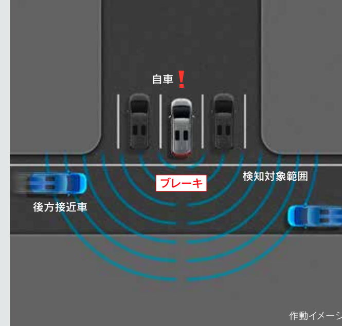
パーキングサポートブレーキ(後方接近車両) [PKSB]
