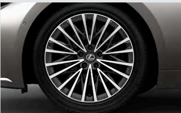
245/45R20ランフラットタイヤ & ノイズリダクションアルミホイール (切削光輝＋ダークグレーメタリック塗装) LS500h LS500
