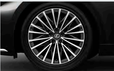
245/45R20ランフラットタイヤ & ノイズリダクションアルミホイール (切削光輝＋ダークグレーメタリック塗装)
