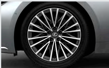
245/45R20ランフラットタイヤ & ノイズリダクションアルミホイール (切削光輝＋ダークグレーメタリック塗装) LS500h LS500
