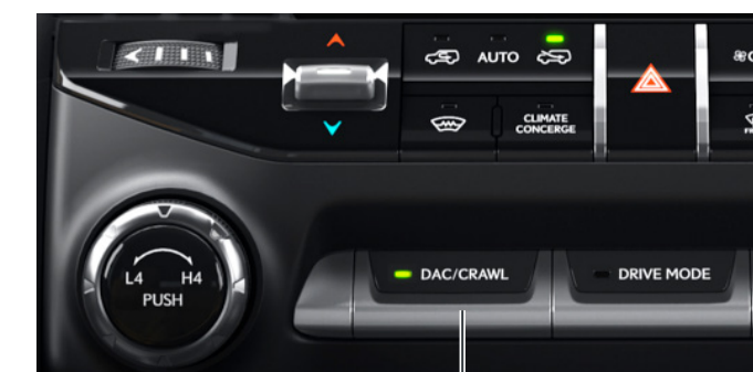
DAC: ダウンヒルアシストコントロールスイッチ CRAWL: クロールコントロールスイッチ
