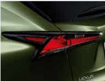
フルLEDリヤコンビネーションランプ (テール・ストップ・バックアップ)
