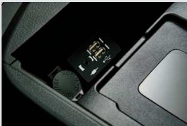
USB (2個) / AUX (音声) 入力端子 (センターコンソール内)
