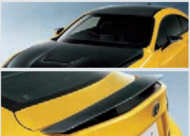
カーボンエクステリアパーツ(エンジンフード・ルーフ)/カーボンアクティブリヤウィング(格納式)
