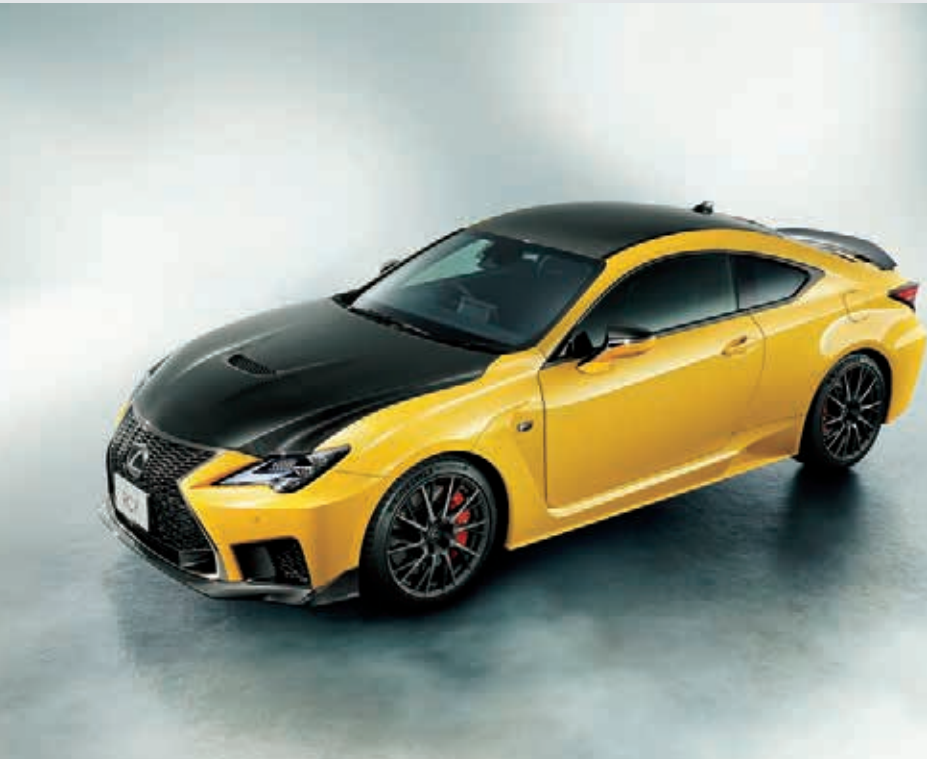
Photo: RC F “Carbon Exterior package”。ボディカラーのネーブルスイエローコントラストレイヤリング(5C1)、カーボンフロントスポイラー、フロント255/35ZR19+リヤ275/35ZR19タイヤ&鍛造アルミホイール(BBS製・切削光輝+マットブラック塗装・スパイラル10本スポーク)、F専用オレンジブレーキキャリパー(フロント・リヤ)はメーカーオプション。
